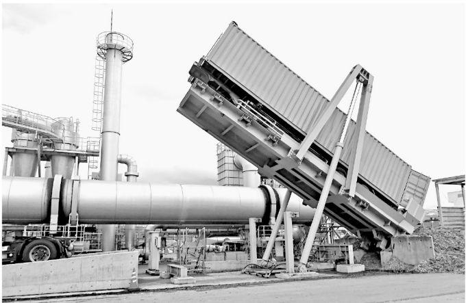
乾燥設備で未利用材チップの含水率を低下させる (ユナイテッドリニューアブルエナジー)
